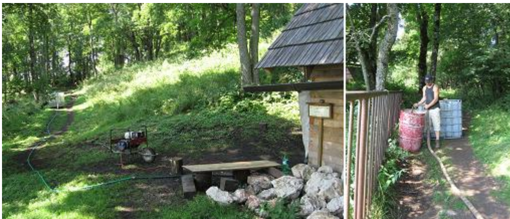
Prečerpávanie vody zo studne k Domu veliteľa cez medzistanice
