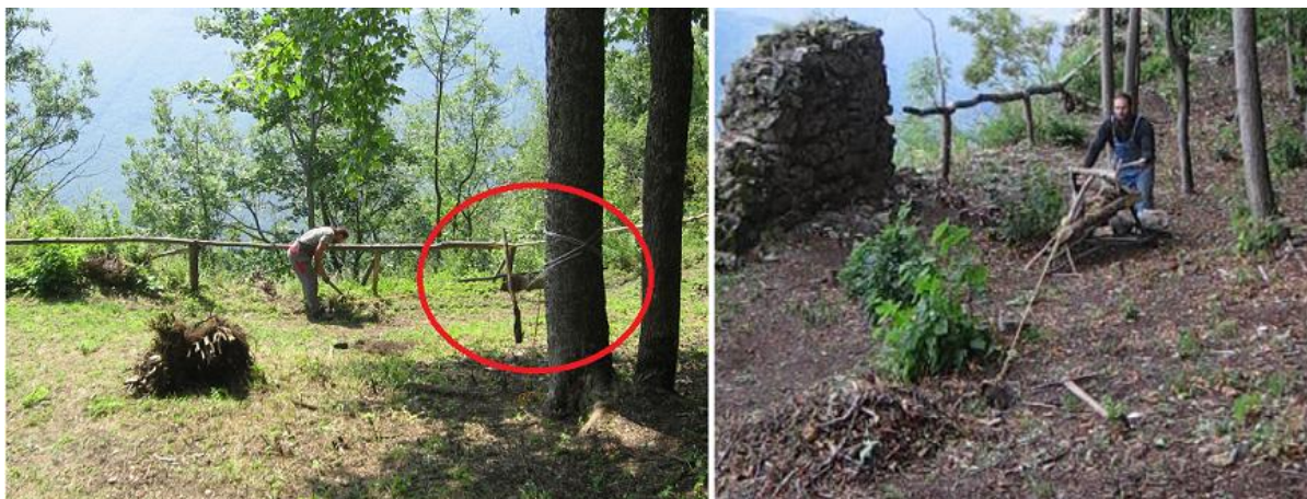
Kľčovrátok – tohtoročný vynález na uľahčenie odstraňovania koreňov, najskôr statický – jeho použitie potrebovalo strom v blízkosti, neskôr aj mobilný, ktorý bolo možné použiť aj na zdvíhanie ťažkých bremien:
